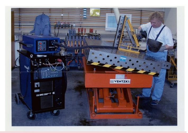
Neukonstruktion eines Schweißtisch der Höhen- und in der Neigung verstellbar ist. Gesamtkosten: ~ 40.000 Euro
