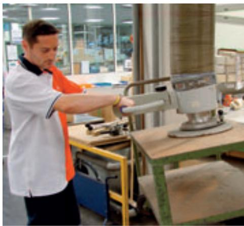
Leichter Transport für schwere Lasten: der Vakuumheber
